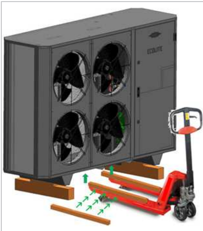
Abb. 7: Anheben mit Gabelstapler
