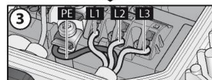
Afb. 2: Aansluiting van de leidingen op klemmen
